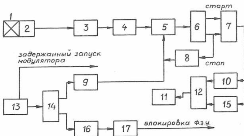
Рис. 2 Блок-схема электроники: 1 - сцинтиллятор; 2 - ФЭУ; 3 - усилитель; 4 - усилитель-ограничитель; 5 - триггер Шмитта; 6 - формирователь "старт" - "стоп"; 7 - время-амплитудный конвертор; 8 - стоповый канал; 9 - формирователь блокировки системы отбора; 10 - дискриминатор верхнего уровня; 11 - пересчитанный прибор ПП-9; 12 - схема антисовпадений ВУ-13; 13 - блок синхронизации; 14 - разветвитель; 16 - блок импульса задержки; 17 - блок управления запрета ФЭУ.
